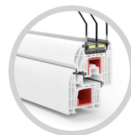
T-Classic Plus 8 chambres profondeur de cadre 70 mm
